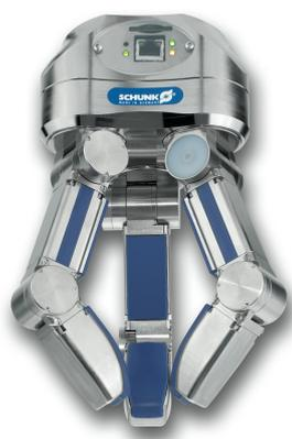
Figura 3.8: Schunk Hand (Dati raccolti da [8]).
