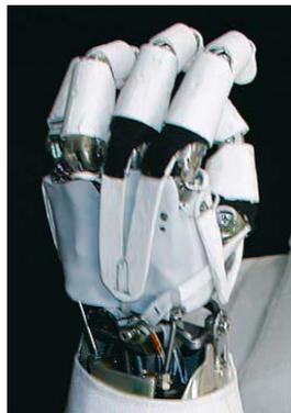
Figura 3.7: Robonaut Hand (Dati raccolti da [2]).
