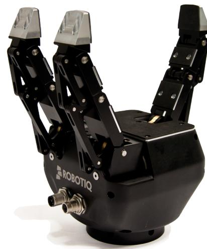
Figura 3.9: Robotiq Hand (Dati raccolti da [12]).
